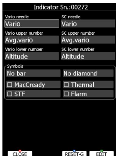
**Der mechanische Zeiger (Vario needle):** kann folgende Werte darstellen: Vario, Netto, Relativ oder Sollfahrt. Im Kreisflug (Vario) oder Geradeausflug (Sollfahrt) können verschiedene Werte angezeigt werden (siehe Bild unten: Vario needle und SC needle. SC = Speed Command = Sollfahrt), sofern der Flugmodus auch umgeschaltet wird (siehe Kapitel 3.12.1.4 und Installationshandbuch). Die Skala ist
