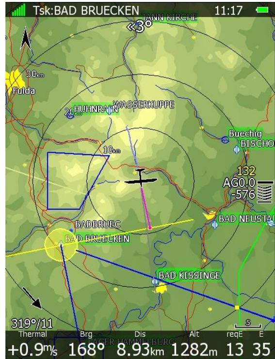
Links ist „Navigate to nearest point nicht“ gesetzt. Der Abflug wird auf den Referenzpunkt der Linie gesetzt (man erhält aber einen Punkt auf der Linie als Hinweis) und der Zielkreis endet erst am Mittelpunkt. Auch die Angaben zum Abflug auf die Linie (Groundspeed und Höhe) erscheinen nicht.
