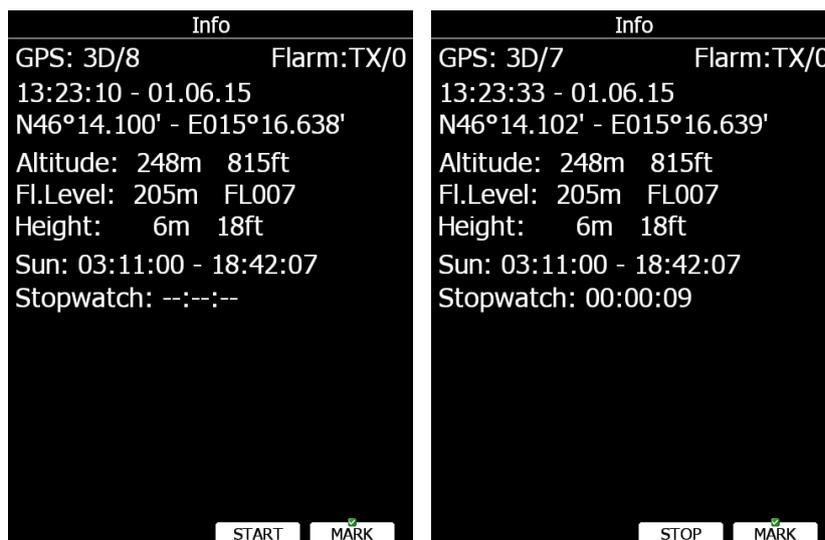
Drücken Sie **Start**, um die Stoppuhr zu Starten, mit **Stop** wird die Zeitmessung beendet.
