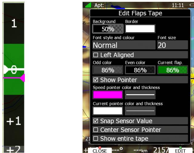
**Show entire tape** bedeutet, dass der gesamte Bereich angezeigt wird, unabhängig von den Grenzen des Speedtapes. Dann läuft der magentafarbene Sollzeiger und der weiße ist-Zeiger über das Band
