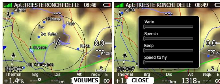
Zugleich wird beim Drehen am Lautstärkereglern das Menü **Volumes** wählbar. Bei Aktivierung dieses Menüs, erscheint ein Auswahlfenster mit 4 Schieberegler, in dem die Lautstärke aller zuvor angesprochenen verschiedenen Sounds direkt verstellt werden kann.
