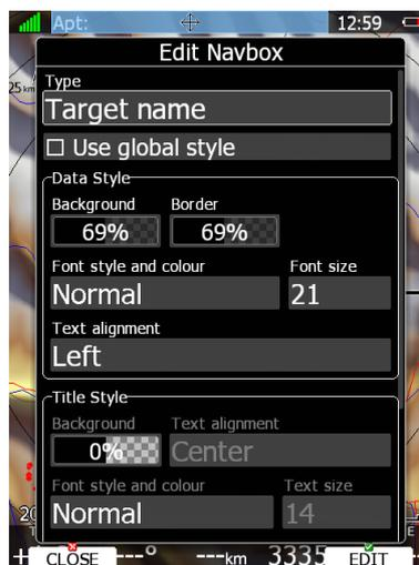
*Einige NavBoxen können mit verschiedenen Einheiten belegt werden, z.B. Höhe in m und in ft. Möchte man den Wert gleichzeitig in unterschiedlichen Einheiten sehen, so muß man die entsprechende NavBox mehrmals einrichten und in einer NavBox jeweils eine Einheit setzen.*
