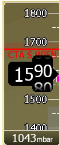
Ein Marker für den nächstgelegenen Luftraum wird angezeigt im APT und WPT Modus. Im Taskmodus wird stattdessen die Höhe des Zielpunktes angezeigt. Last but not least wird der letzte Aufwind in der entsprechenden Farbe (siehe 4.3.2) dargestellt.
