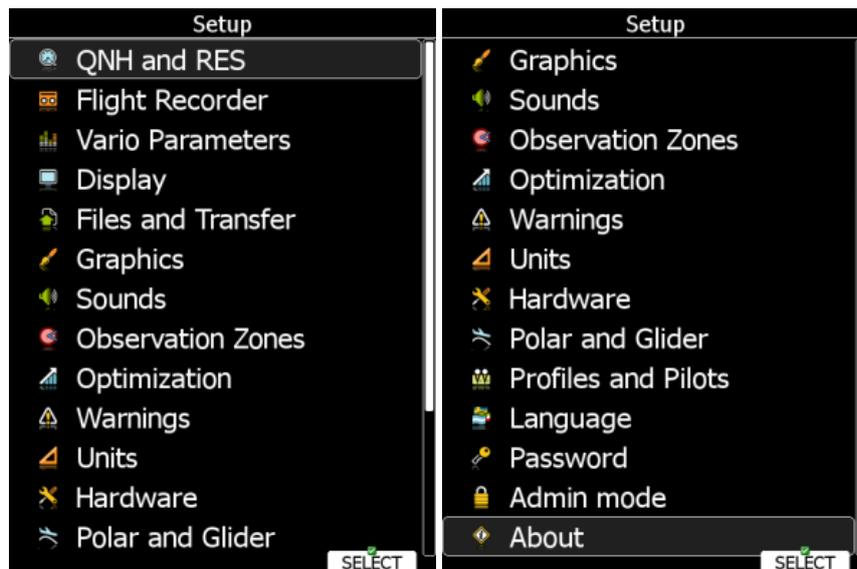
Mit dem **Up/DOWN-Drehschalter** werden die verschiedenen Menüs – Positionen von **QNH and RES** bis **About** angewählt, auf der Fernbedienung verwenden Sie hierfür den Joystick in Up/Down-Richtung. Betätigen des Drucktasters bei „Select“ eröffnet den gewählten Menüpunkt. Mit dem **Zoomdrehschalter** springen Sie schneller durch die Auswahl, auf der Fernbedienung verwenden Sie hierfür den Joystick in Links/Rechts-Richtung.
