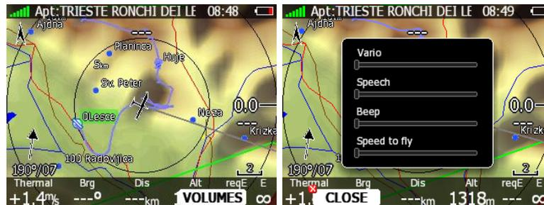
Zugleich wird beim Drehen am Lautstärkeregler das Menü Volumes wählbar. Bei Aktivierung dieses Menüs, erscheint ein Auswahlfenster mit 4 Schieberegler, in dem die Lautstärke aller zuvor angesprochenen verschiedenen Sounds direkt verstellt werden kann. Auswahl des einzelnen Reglers mit dem UP/DOWN Drehschalter, verändern des Werte mit dem Lautstärkeregler.
