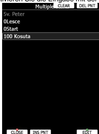
Der erste Startpunkt ist ausgegraut, da er ja schon in der Aufgabe verwendet wird. Gehen Sie mit Cursor eine Zeile darunter und geben Sie dort mit EDIT einen weiteren Startpunkt ein. Wiederholen Sie diese Prozedur so oft wie nötig. Im Flug kann man dann mit der Taste CYCLE die Startpunkte anwählen.
