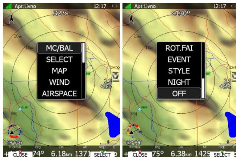
Mit dem UP/DOWN-Tastern am Knüppel (⇅) kann der Pilot nun die einzelnen Punkte auswählen und mit Enter (✓) bestätigen. Belegung der Knüppelfernbedienung siehe Kapitel 9.3.2.
