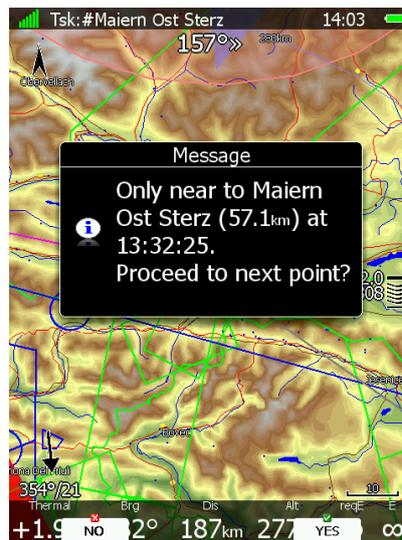
Sie erhalten eine Meldung über den Abbruch der Aufgabe an diesem Wendepunkt. Wenn Sie mit YES bestätigen, wird weitergeschaltet zum nächsten Punkt, für Statistik wird die Aufgabe mit dem optimalen Punkt neu berechnet.
