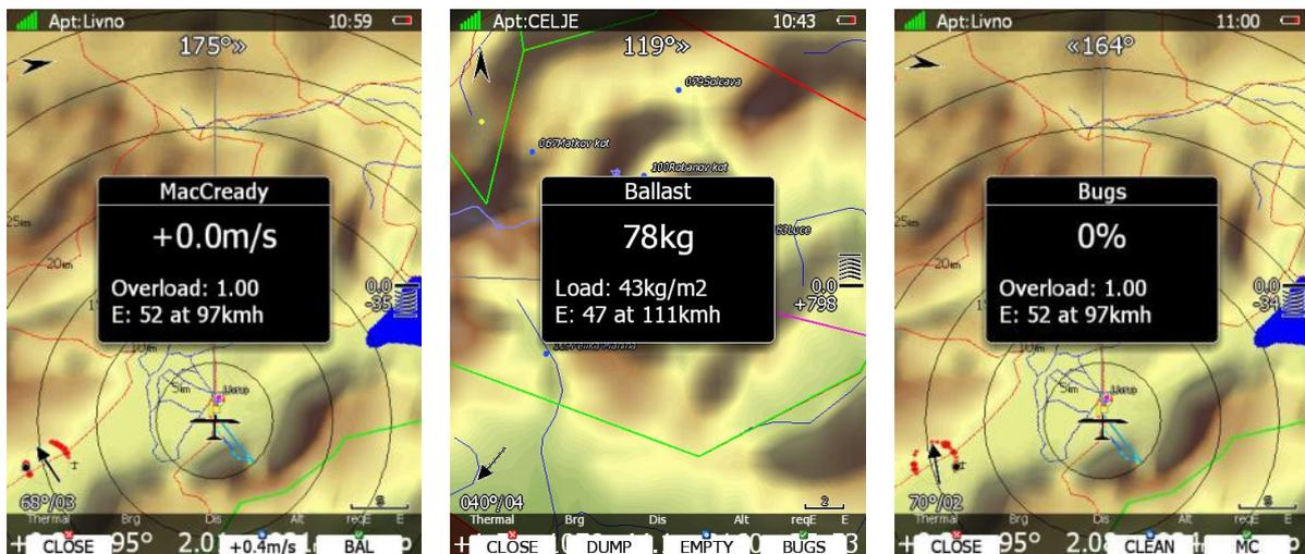
Mit dem UP/DOWN-Drehschalter können Sie die einzelnen Werte verstellen (→ 5.1.7.3)
