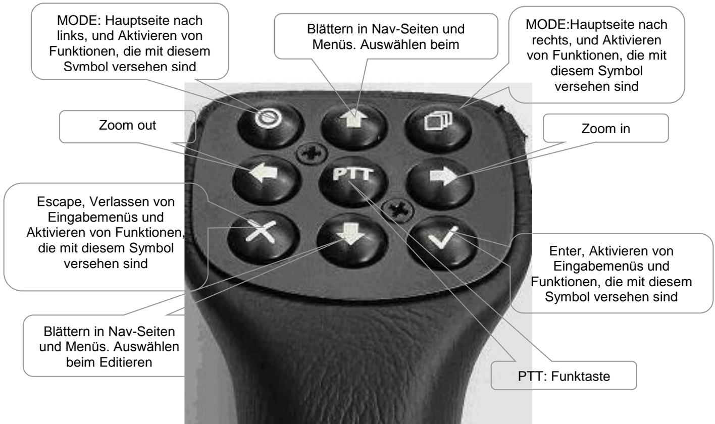
Haben Sie diese Bauform, geben Sie im Setup unter Hardware „LX8000 mit 9 Tasten“ ein. Für das Tastaturlayout gibt es ein Upgrade, falls Sie von älteren LX-Systemen mit dem alten Tastaturlayout kommen und diese Fernbedienung weiterverwenden wollen. Es ist aber auch möglich das ältere Layout zu verwenden. Geben Sie dann bitte „LX7007 Fernbedienung“ ein. Siehe Kapitel 3.12.7 Diese Einstellungen sind für eine zweite Fernbedienung (Doppelsitzer, side by side) separat durchzuführen
