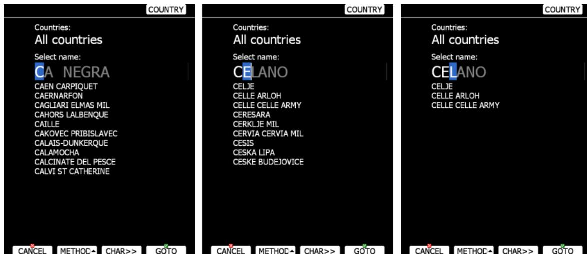
Kennt man den Namen nicht ganz genau, oder will bei der Eingabe Zeit sparen, so kann man nach einer geeigneten Anzahl von Buchstaben bereits mit einmal **GOTO** abbrechen und mit dem UP/DOWN-Drehschalter (rechts unten) durch die angebotene Liste blättern. Wieder wird am Ende der Flugplatz in der ersten Zeile mit dem zweiten **GOTO** bestätigt.
