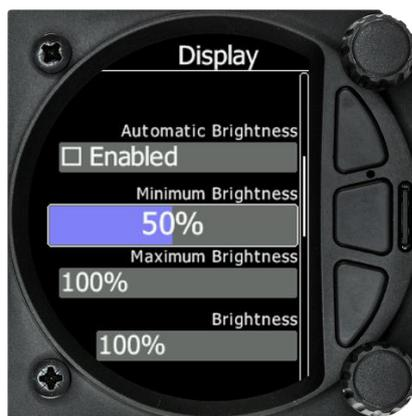
Un appui du bouton rotatif du bas permet de sélectionner le curseur et la rotation du bouton permet d'en ajuster la valeur. Confirmez la valeur en pressant le bouton.
