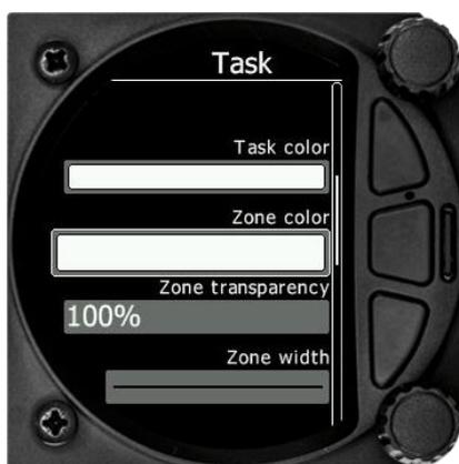
Ce sous-menu vous permet de changer la couleur de la ligne du circuit, des zones de point de virage et modifier la transparence et la largeur des bordures de ces zones.
