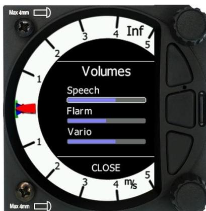
Le bouton rotatif du bas sert à ajuster les paramètres dans le mode actuel ou dans les menus. Avec celui-ci, l'utilisateur peut accéder au calage Mac Cready, aux ballasts et au bugs setting (pourcentage de dégradation de la polaire).
