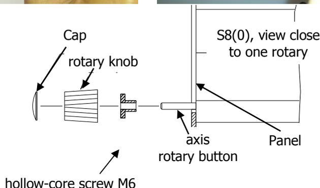
Enlevez les caches sur chaque bouton rotatif en utilisant un couteau ou un tournevis plat. Dévissez ensuite chaque bouton rotatif en le tenant. Enlevez les deux vis restantes et les deux écrous filetés M6. Installez le LX dans tableau de bord et revissez toutes les vis, écrous et les boutons rotatifs. Veillez à ce qu'il y ait assez de place entre le tableau de bord et les boutons rotatifs pour que ceux-ci puissent être poussés.
